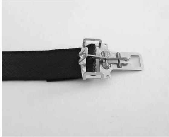
6. Prendere ora un assieme della fibbia con il supporto a telaio, passarlo nel tessuto, incollare un pezzo di biadesivo e dopo aver rimosso la carta protettiva ripiegare e incollare il lembo aperto del tessuto - Now take an assembly of the buckle with the frame support, pass it through the fabric, glue a piece of double-sided tape and after removing the protective paper, fold and glue the open edge of the fabric
