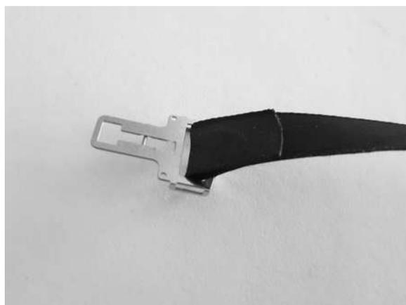
5. Incollare il gancio sulla fibbia centrale, assicurarsi che il perno una volta che la colla sarà asciutta, possa muoversi. Piegare ulteriormente il flap posteriore per allinearlo con il gancio - Glue the hook onto the central buckle, make sure that the pin can move once the glue is dry. Fold the rear flap further to align with the hook.
