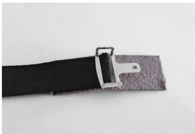
9. Prendere ora un assieme della fibbia con il supporto a telaio, passarlo nel tessuto, incollare un pezzo di biadesivo e dopo aver rimosso la carta protettiva ripiegare e incollare il lembo aperto del tessuto - Now take an assembly of the buckle with the frame support, pass it through the fabric, glue a piece of double-sided tape and after removing the protective paper, fold and glue the open edge of the fabric
